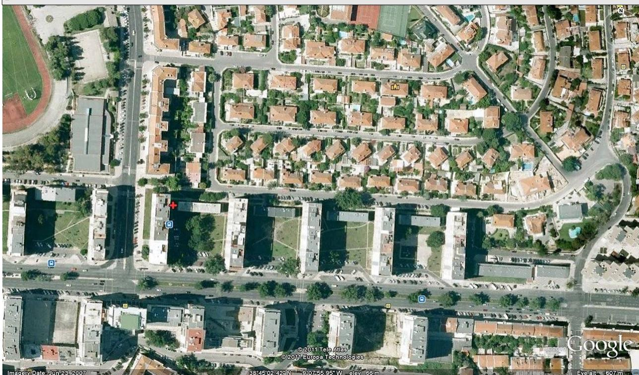
A adopção das técnicas solar-passivas, estritamente pautada pela eficiência energética visando o conforto interior, conduz à arregimentação dos edifícios em filas paralelas aproximadamente na direcção E-O, o que contraria frontalmente a tradicional e desejável diversidade urbana.
